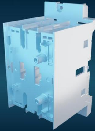
Dieses Werkzeug wurde aufgrund der aufwändigen Artikelgeometrie als 2-fach Werkzeug mit je 4 Schiebern pro Kavität realisiert. In der Serienfertigung stellt vor allem das stark abrasive Material in Kombination mit der komplexen Geometrie an der Artikelinnenseite und den sehr präzisen Kammerkernen eine Herausforderung dar. Zusätzlich ist Belagsbildung aufgrund der Flammenschutzadditiven ein Faktor für die Artikelqualität.
