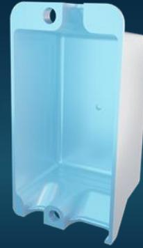
Dieser Artikel sorgt für die Abschirmung der Geräteelektronik gegen Röntgenstrahlung im Computertomograf. Durch die Entwicklung eines neuartigen Kunststoffes mit 96% Wolframfüllung konnte das vormals verwendete Blei ersetzt werden. Unser Haus hat die Entwicklung unter dem Anwenderaspekt im Spritzguß begleitet. Besondere Herausforderungen in der Verarbeitung liegen in der homogenen Verteilung der Füllstoffe und der schwierigen Verarbeitung des stark abrasiven Materials.
