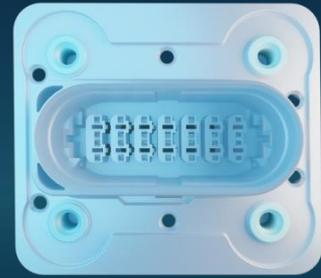
Bei diesem gedichteten Steckverbinder werden vier Messingbuchsen automatisch per Rütteltopf zugeführt und über ein Handling in das Spritzgußwerkzeug eingelegt. Während des Entnahmeprozesses überprüft eine Kamera die Position der Buchsen. Zur Prozess- und Qualitätsüberwachung wurden Innendruckensoren in jeder Kavität verbaut. Die Verarbeitung von Flammenschutzmaterial erfordert das Aufbringen einer Antihaftbeschichtung.
