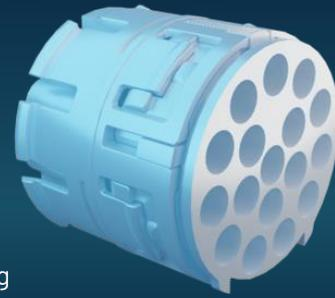
Das zugehörige Werkzeug wurde als 4+4-fach Werkzeug realisiert und die beiden Bauteilhälften werden an der Spritzgußmaschine automatisch montiert und nach Kavitäten sortiert und verpackt. Zur Prozess- und Qualitätsüberwachung wurden Innendruckensoren in jeder Kavität verbaut. Die Verarbeitung von Flammenschutzmaterial, welches zudem laserbeschriftbar ist, erfordert das Aufbringen einer Antihafbeschichtung.
