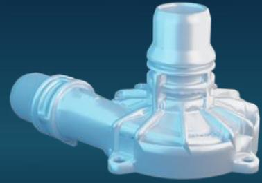
Dieses Bauteil wurde als 4-fach Werkzeug realisiert. Besonderheiten des Werkzeugkonzepts umfassen ein spezielles Heißkanalsystem mit Nadelverschluss, ein düsenseitiges Auswerferpaket und Unterflurschieber. Der Artikel selbst wird aus PPA GF40 gefertigt und im Thermomanagement von Verbrennungs- oder Elektromotoren eingesetzt.
